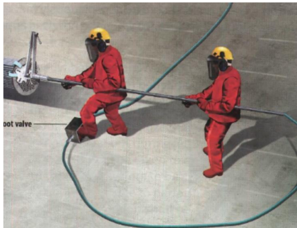
Figura 09 – Operador adicional para auxiliar hidrojatista com manuseio da lança.
