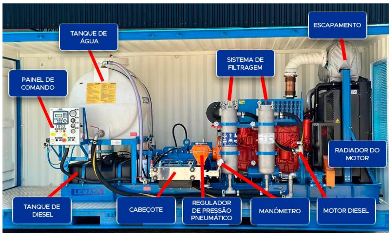
Figura 01 – Sistema de Hidrojateamento – pode estar alocado em base fixa ou em caminhão
