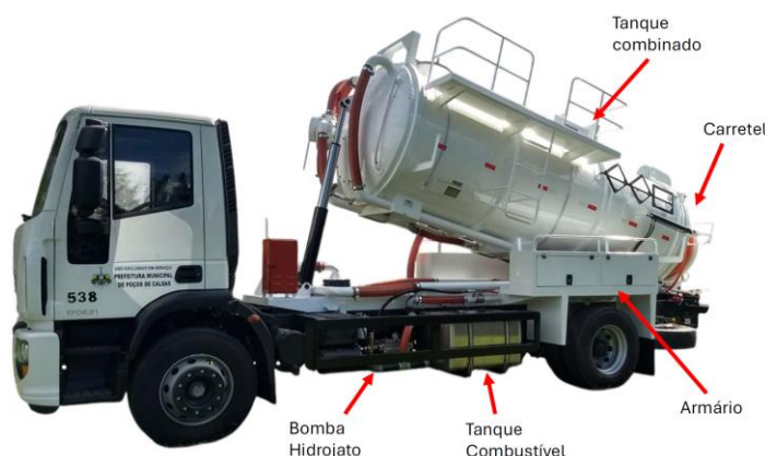
Figura 03 - Caminhão Combinado – Vista bomba hidrojato.
