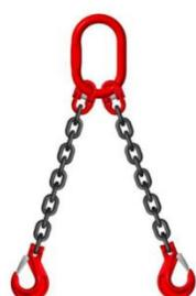
Conjunto para até 10,0t sobre o SKID, utilizar conjunto de correntes diâmetro 16mm (5/8") com dois ramais comprimento 1,50 metros, com anel de carga e ganchos forjados com travas forjadas, para cargas superiores a 10,0t o projeto deve ser analisado conforme procedimento.
