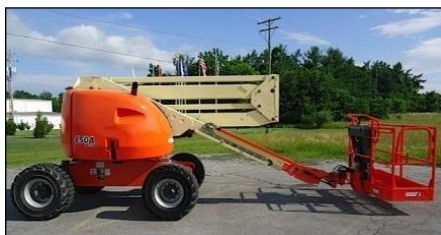
Plataforma elevatória móvel de trabalho – PEMT
